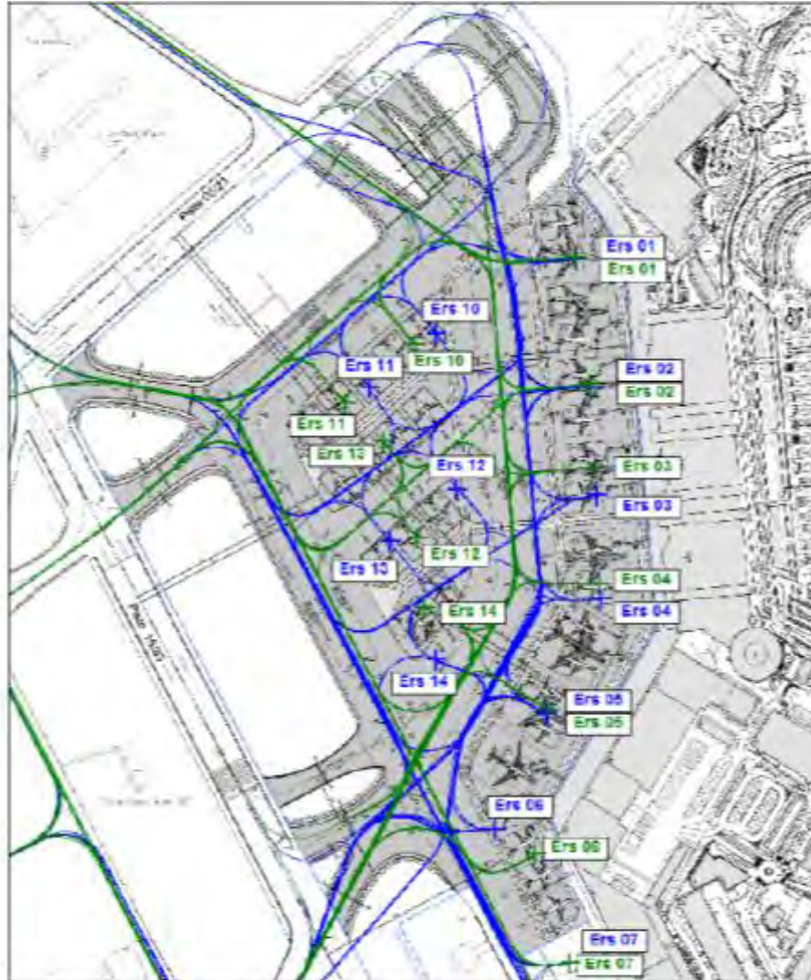
Abbildung 2. Lage der Rollwege, Parkpositionen und APU-Einsätze im EDV-Berechnungsmodell im Prognose-Nullfall (blaue Farbe) und Prognose-Planfall (grüne Farbe).
