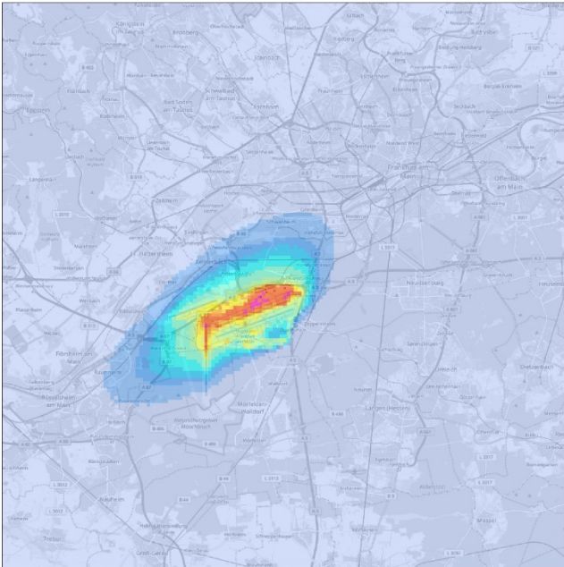
Abbildung 49: Jahresmittel 2015 der bodennah berechneten Konzentration von NO x in µg/m 3 für die Quellgruppen Kfz-Verkehr des Umlandes, Flugbetrieb und Bodenabfertigung, Hintergrundbelastung sowie Gesamtbelastung.
